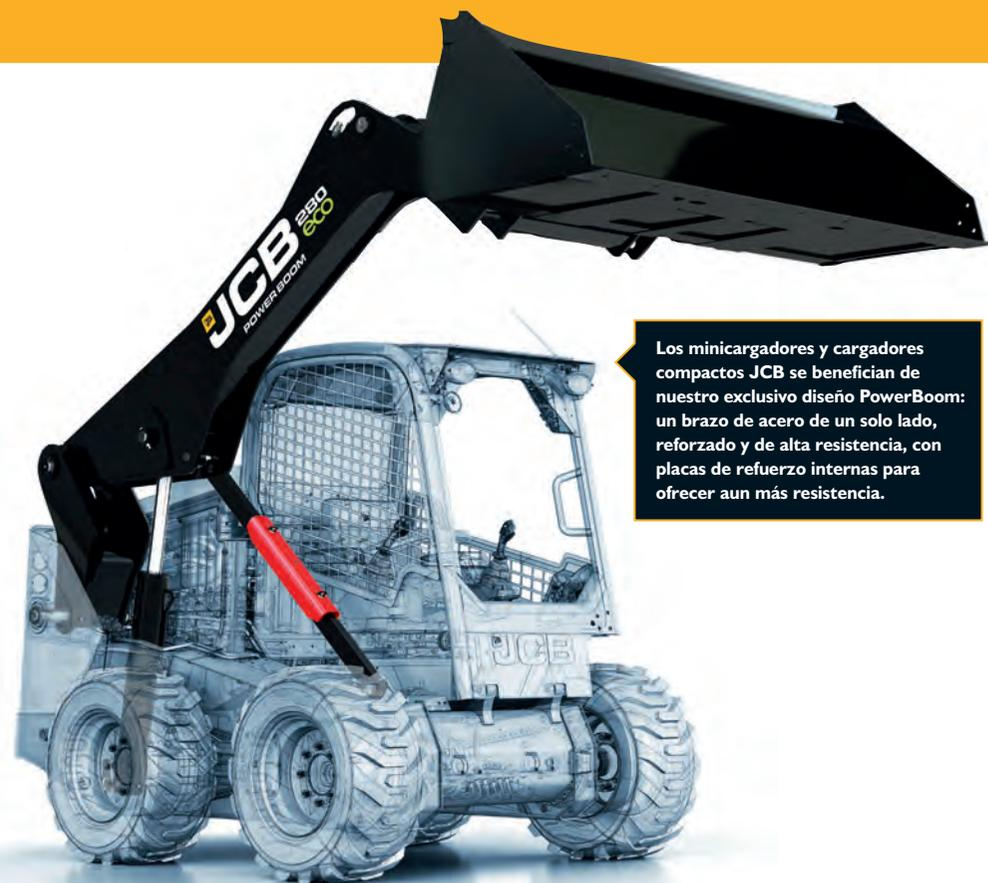
Los minicargadores y cargadores compactos JCB se benefician de nuestro exclusivo diseño PowerBoom: un brazo de acero de un solo lado, reforzado y de alta resistencia, con placas de refuerzo internas para ofrecer aun más resistencia.
