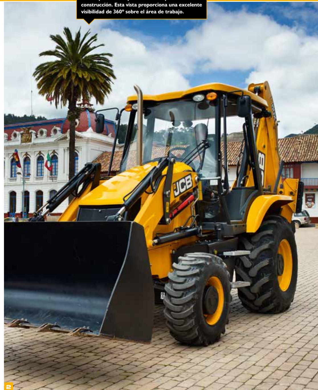
En una JCB 3CX, los operadores se sientan más arriba que en la mayoría de las máquinas de construcción. Esta vista proporciona una excelente visibilidad de 360° sobre el área de trabajo.
