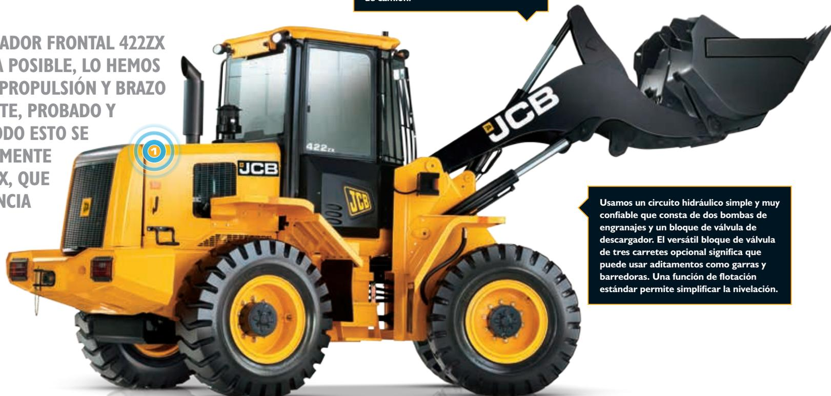
Usamos un circuito hidráulico simple y muy confiable que consta de dos bombas de engranajes y un bloque de válvula de descargador. El versátil bloque de válvula de tres carretes opcional significa que puede usar aditamentos como garras y barredoras. Una función de flotación estándar permite simplificar la nivelación.
